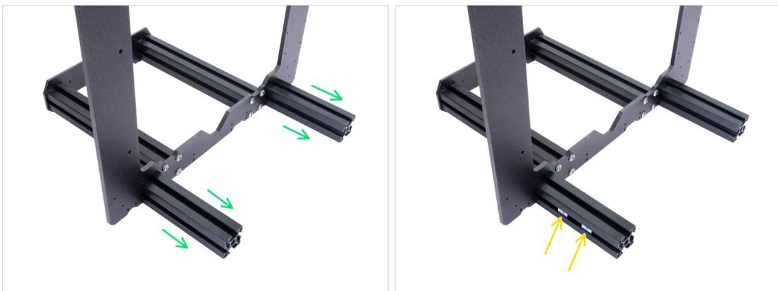
**DIESER SCHRITT IST SEHR WICHTIG!** Eine falsche Montage der Halter für das Netzteil wird später zu Problemen führen.
