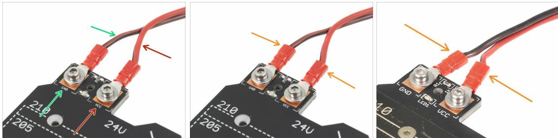
⚠ 先に進む前に、ケーブル がヒートベッ ドに正しく接続され、適切に締め付けられていることを再度確認してください。そうしないと、プリンタ ーに損傷を与える危険性があります！。
