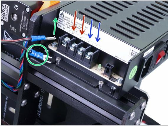
**⚠ 警告: ケーブル が正しく接続されているか数回確認してください!!! ケーブル が正しく接続されていない場合、電源ユニットまたはプリンター自体を損傷する恐れがあります!!!**
