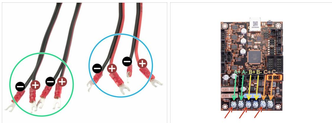
**⚠ 重要:** 電源ユニットとヒートベッドのケーブルを、正しい順番で EINSY ボードに接続することは、極めて重要です。プラス側のケーブルは、プラス側のスロットに接続する必要があります。ケーブルの色分け方法には、2種類のバージョンがあります。
