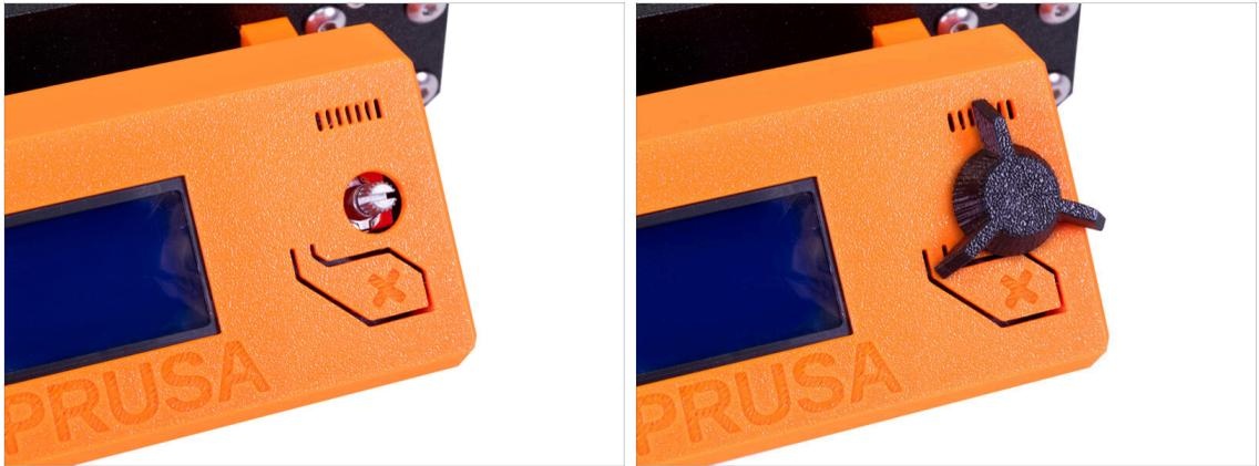
◆ 写真のように、LCD-knob を取り付けます。
