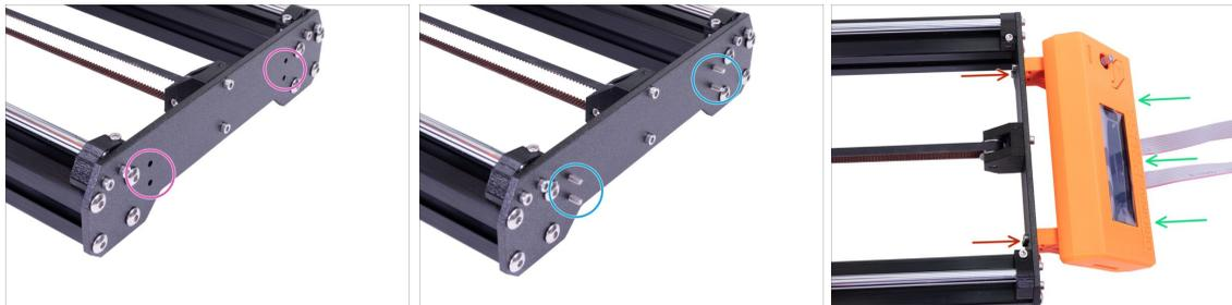
**⚠ 注意!!!** このステップで、プリンターの前面に LCD が取り付けられます。まだ制振材を取り付けていない場合は、いま取り付けてしまってください。後ほど組み付けるのであれば、LCD ホルダー にダメージを与えないよう、十分に気を付けて作業を行ってください。制振材の組み付け方は、第2章 をご確認ください
