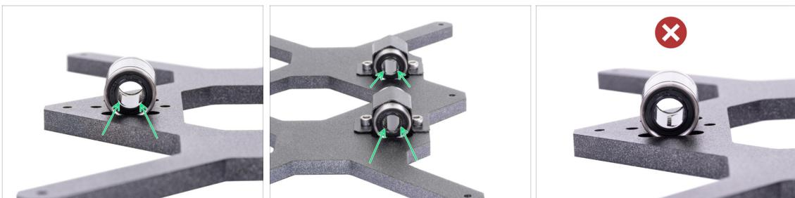
● 正しい方向: ベアリングを Y キャリッジに配置するときは、両方の写真に示されている方向に合わせてください。トラック (ボールの列) は側面にある必要があります。
