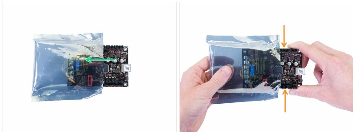
⚠ 警告: 静電気放電 (ESD) から電子機器を保護していることを確認してください。必要な時には電子機器を開梱するようにしてください!
