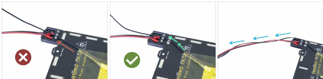
⚠ 黒のサーミスターの配線は、張った状態にならないようにし、ヒートベッドの下で少したわみを持った状態となるようにしてください。こうすることで、プリント中のヒートベッドの動きによって、ケーブルが引っ張られ、ヒートベッドの中心から外れてしまうことができます。
