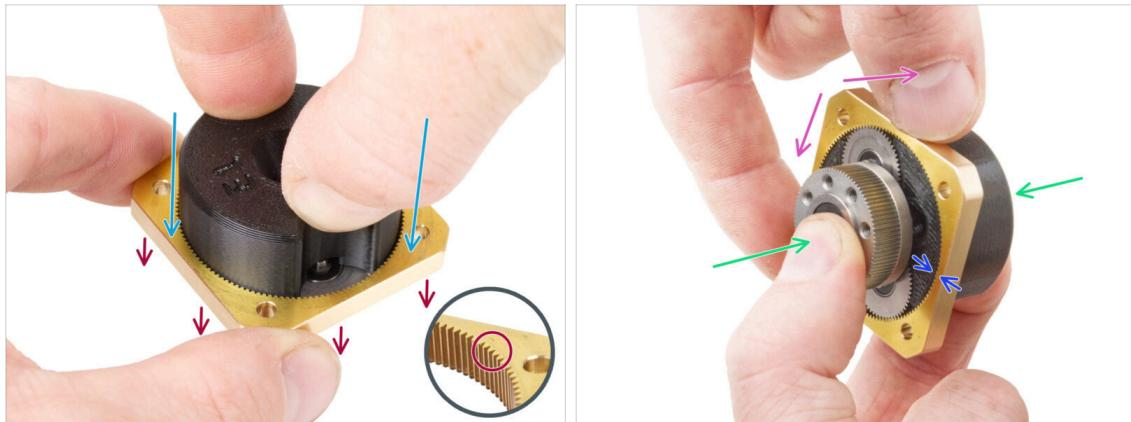
**⚠️ Bauen Sie das Getriebe nicht ohne den PG-Montageadapter zusammen.** Dieses Werkzeug soll sicherstellen, dass die Zahnräder richtig zusammenpassen.
