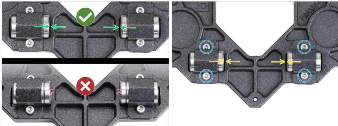
**⚠ Die korrekte Ausrichtung der Lager ist von entscheidender Bedeutung. Gehen Sie vorsichtig vor und stellen Sie sicher, dass beide Lager so nah wie möglich an der Mitte des Y-carriage sind und keine Aussparungskante berühren.**
