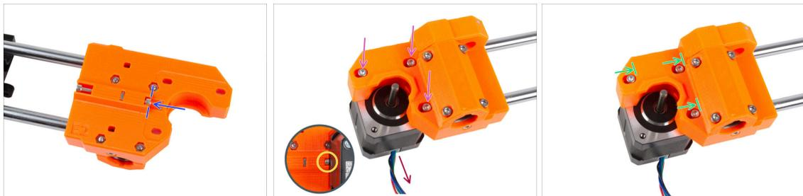
● Setzen Sie die M3x10-Schraube in den X-End-Motor ein. Richten Sie sie an der Kante des Kunststoff-Vorsprungs aus. Ziehen Sie die Schraube nicht fest, da dort kein Gewinde ist, sondern setzen Sie sie einfach frei ein.
