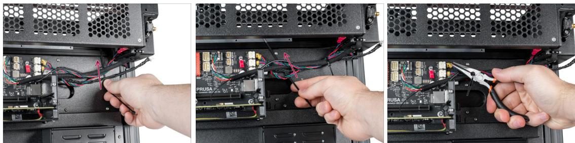
**⚠ Achtung:** Ziehen Sie die Kabelbinder nicht zu fest an! Sonst riskieren Sie eine Beschädigung der Kabel.
