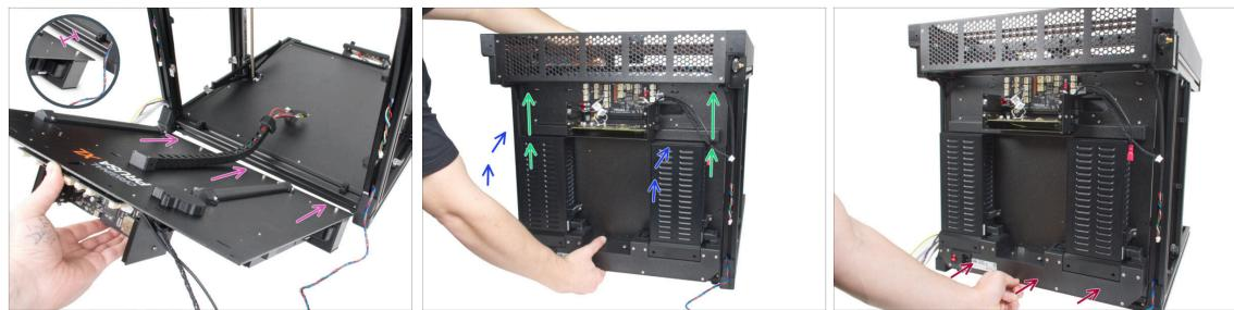
**⚠ ¡Sujeta el panel trasero XL con la mano durante el montaje! No está fijado con ningún tornillo.**
