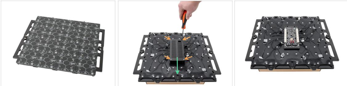
⚠️ **ATTENZIONE:** assicurati che il tuo spazio di lavoro sia pulito prima di iniziare a lavorare con il piano riscaldato. Usa un tappetino morbido (panno o cartone) per evitare di graffiare i componenti del piano riscaldato.
