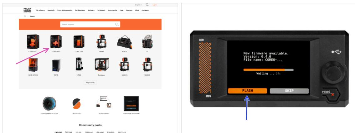
➊ Tutte le stampanti sono dotate di una chiavetta USB contenente il firmware più recente. Tuttavia, si consiglia di controllare e, se necessario, aggiornare la versione del firmware ogni poche settimane.
