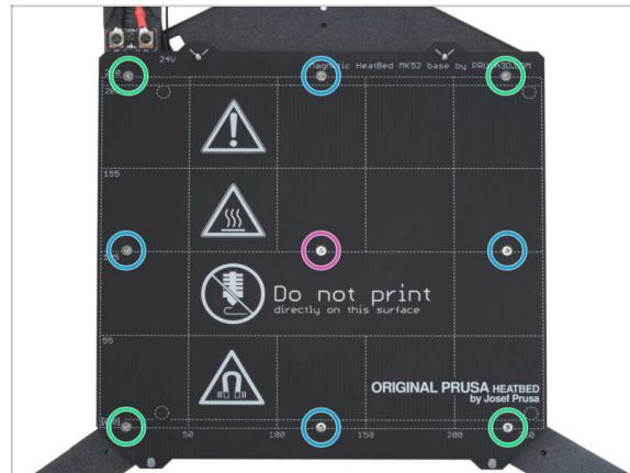
⚠️ **IMPORTANTE:** il piano riscaldato va avvitato seguendo un ordine preciso. Ripeti la sequenza più volte, assicurandoti di dare un ultimo giro di avvitamento dopo almeno due giri.
