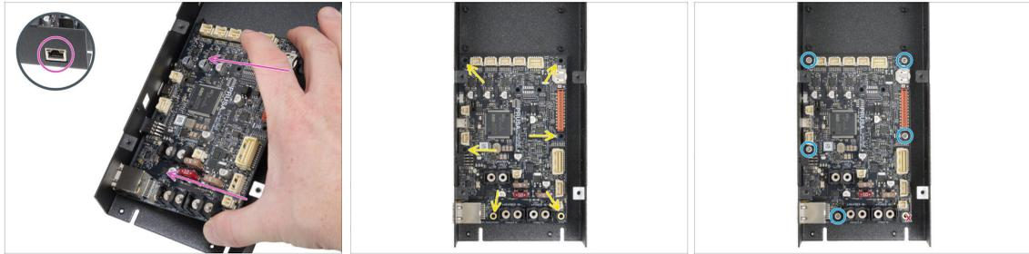
**⚠️ Berühren Sie beim Hantieren mit der Elektronikplatine immer nur die Seiten der Platine. Vermeiden Sie es, die Chips, Kondensatoren und andere Teile der Elektronik zu berühren.**
