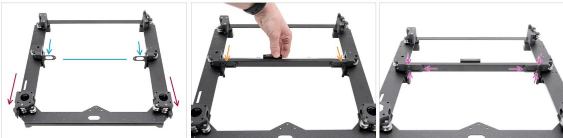
● Positionieren Sie die Baugruppe so, dass die Motorhalterungen zu Ihnen zeigen.
