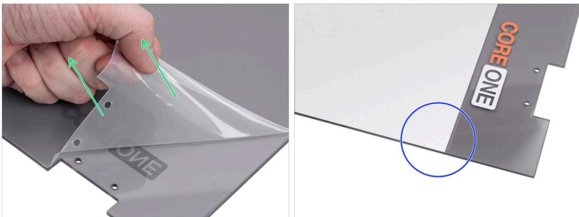
● **Die Türverkleidung ist auf beiden Seiten mit einer Schutzfolie versehen.** Eine bedeckt die gesamte Oberfläche, die andere nur den mittleren Bereich.
