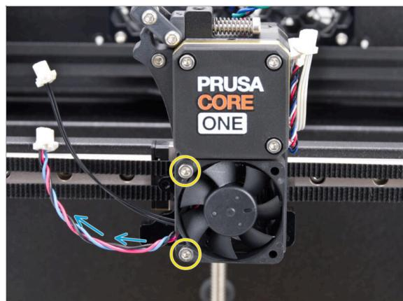
◆ Fissa la ventola dell'hotend sul dissipatore con due viti M3x18 sul lato sinistro. **Stringi le viti delicatamente, ma con decisione, altrimenti l'alloggiamento in plastica potrebbe rompersi.**
