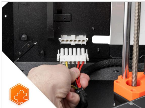
◆ Esta guía le llevará a través de la instalación del **Cable de alimentación de liberación rápida** en el **Original Prusa Enclosure**.
