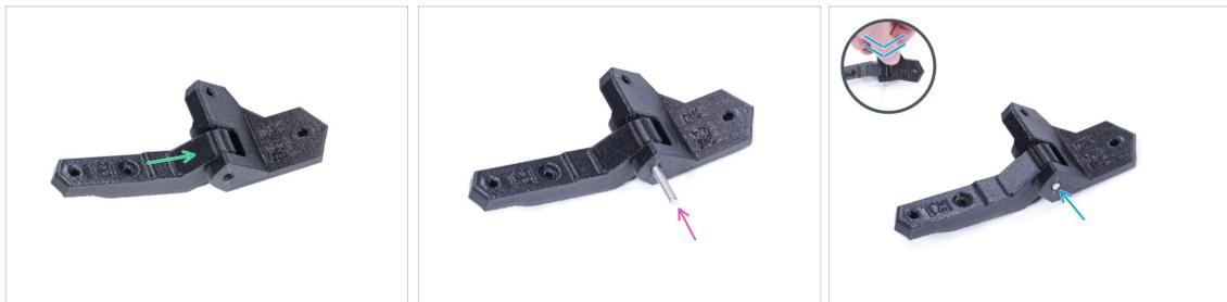
■ Insérez le Hinge-lever dans le Hinge-bracket-R.
