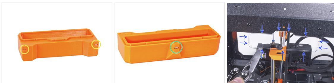
**■** Insérez deux écrous M3nS par le côté dans chaque poignée de transport.
