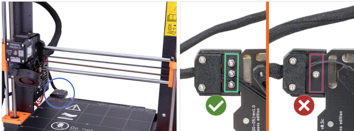
⚠ **Das Upgrade von MK3S/MK3S+ auf MK3.5 ist mit dem Heizbett kompatibel, das über verschraubte Stromkabel verfügt.**
