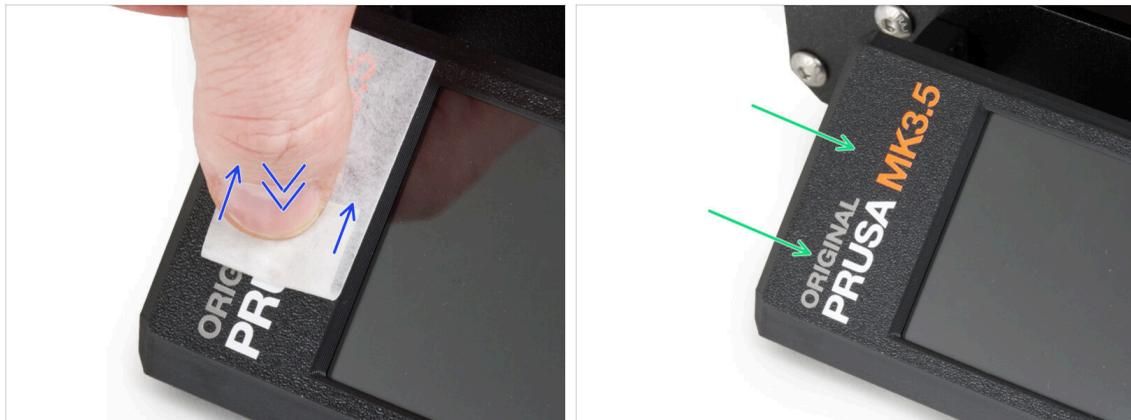
**⚠** Dieser Prozess erfordert Geduld und Sorgfalt. Die perfekte Haftung hängt von der richtigen Entfettung des Bauteils und der Umgebungstemperatur ab.
