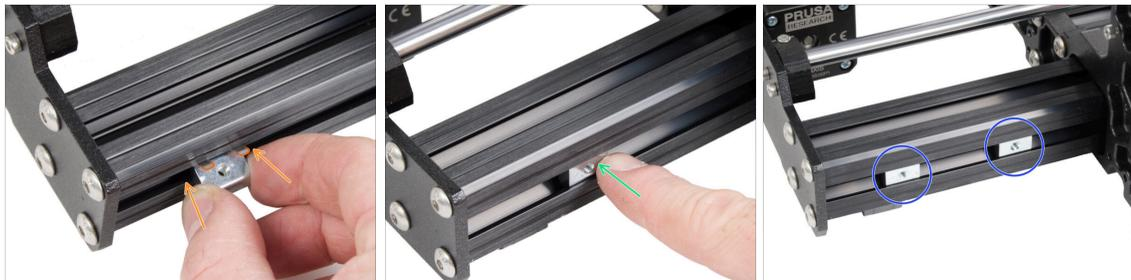
● Inserta la tuerca M3nEs en la extrusión corta izquierda (lado sin la fuente de alimentación). Inserta primero el lado con el muelle (placa metálica).
