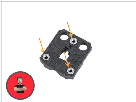
● Stecken Sie drei M3n-Muttern in die entsprechenden Öffnungen in der Heatbed-cable-cover-bottom.
