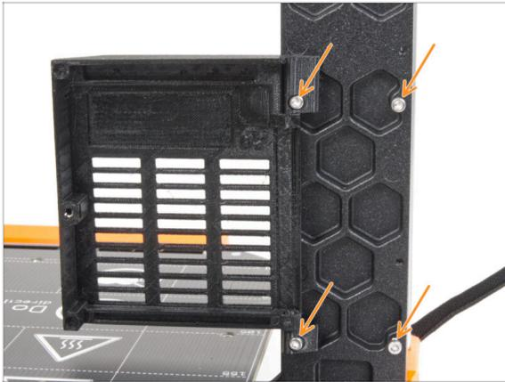
🔸 Lösen und entfernen Sie alle vier M3-Schrauben zusammen mit der Einsy-door.
