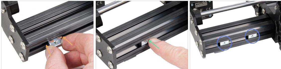
◆ Stecken Sie die M3nEs-Mutter in das linke kurze Profil (Seite ohne Netzteil). Setzen Sie die Seite mit der Feder (Metallplatte) zuerst ein.
