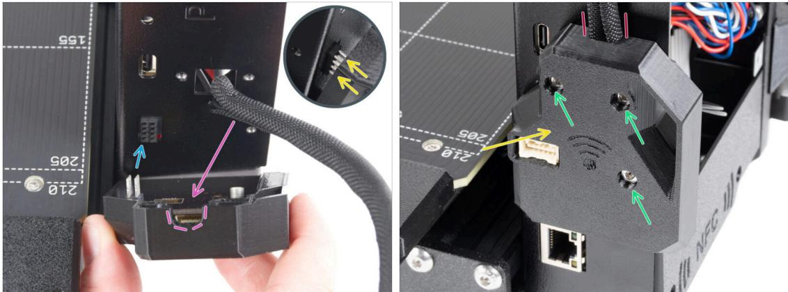
**⚠** **Sein Sie sehr vorsichtig bei der Handhabung und dem Anschluss des ESP-Moduls, um ein Verbiegen und Beschädigen der Stifte zu vermeiden.**
