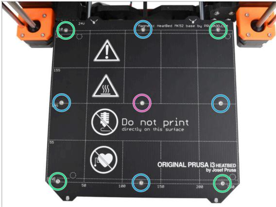
● Nachdem alle Schrauben angebracht wurden, ziehen Sie sie mit einem T10-Schlüssel in der folgenden Reihenfolge fest:
