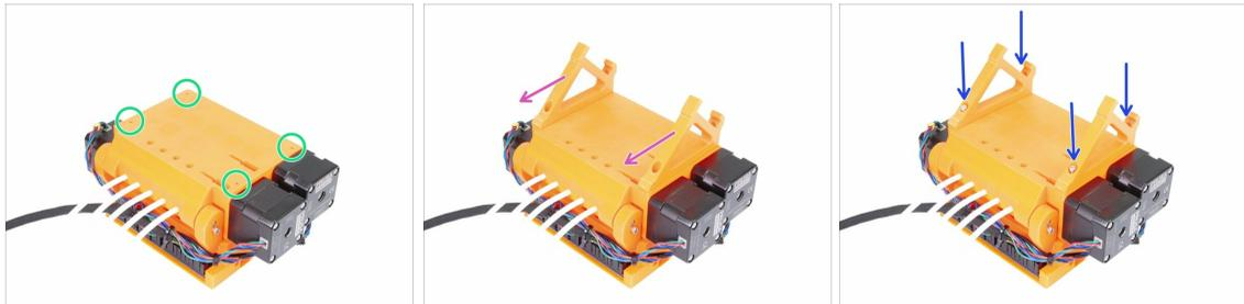
⚠ Quando l'unità MMU2S è capovolta sotto sopra, fai MOLTA attenzione al cavo della SuperFINDA che può rompersi se inclini il sensore SuperFINDA.
