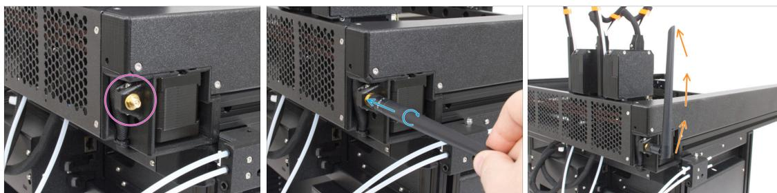
● Localiza el conector de la antena Wi-Fi en la esquina posterior derecha de la impresora.
