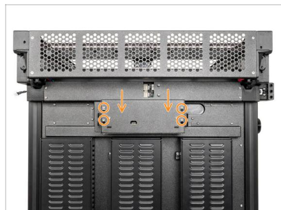
ⓘ En este paso, cubre temporalmente la electrónica. Esto es para proteger la electrónica durante la instalación de los cabezales en el capítulo siguiente. No es necesario apretar la cubierta de la electrónica.
