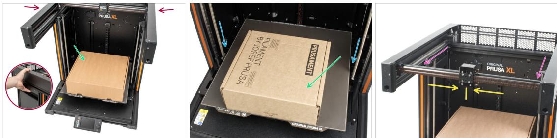
**⚠ Rappel : Pour manipuler l'imprimante, saisissez toujours les poignées des deux côtés de l'imprimante. Ne soulevez pas l'imprimante par les profilés aluminium ou les profilés en tôle situés sur le dessus.**
