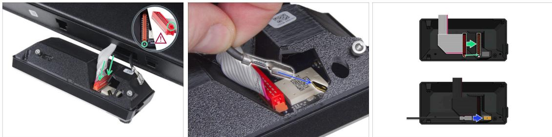
● Connectez le câble du xLCD (câble gris avec connecteur rouge) à la carte du xLCD à l'arrière de l'assemblage du xLCD. **Ne tirez pas sur le câble !**
